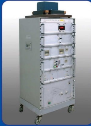
دستگاه اندازه گیری خواص مغناطیسی فولادهای الکتریکی (دستگاه تست اپشتین)
